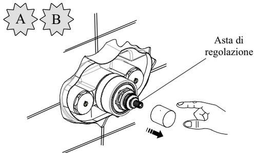
Rimuovere la protezione in plastica senza ruotare l'asta di regolazione brocciata
