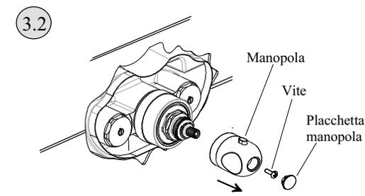
Togliere la placchetta, svitare in senso antiorario la vite e rimuovere la manopola di regolazione
